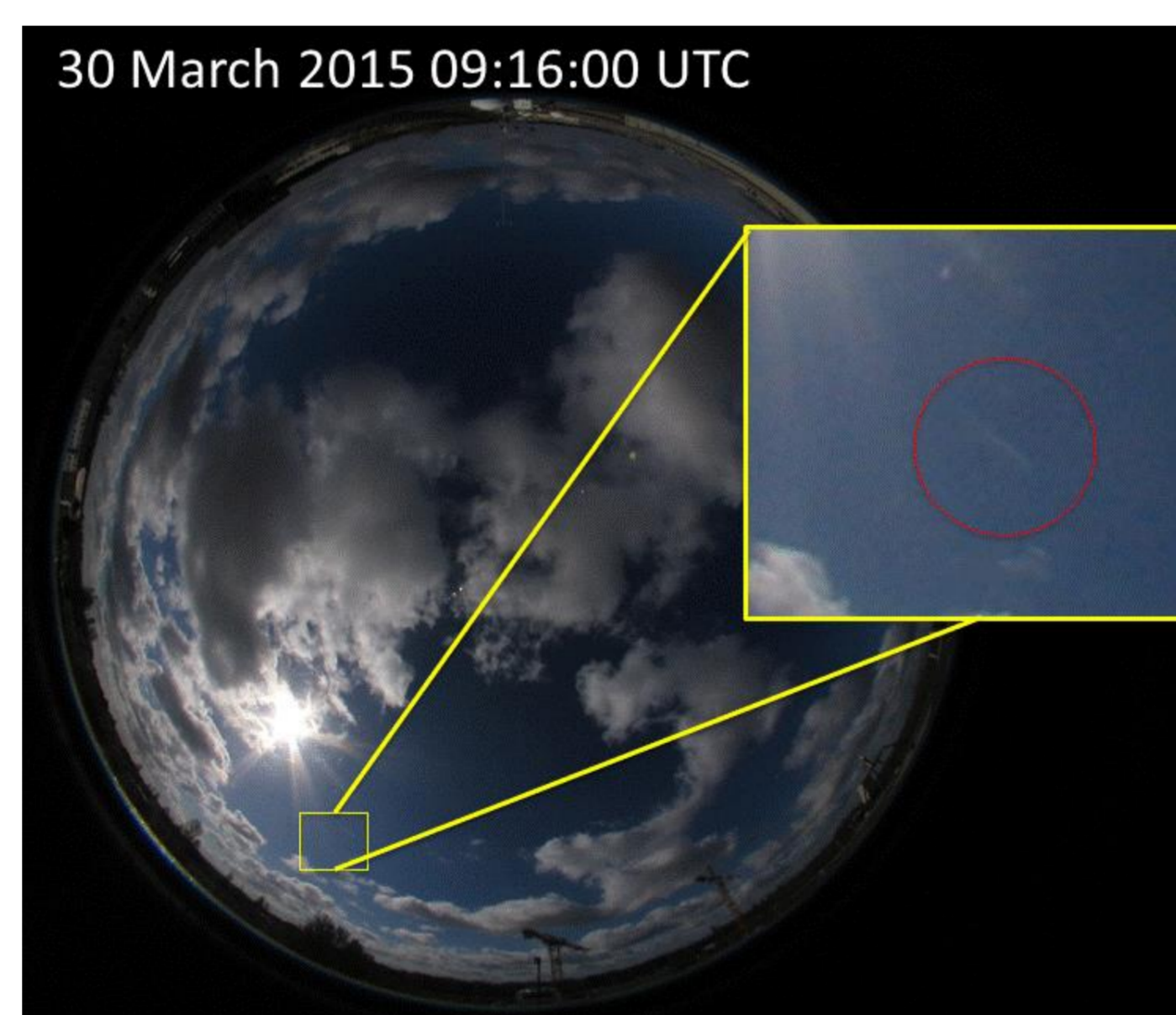
Détection visuelle avec la caméra « fisheye » (photo en mode sous-exposé)
