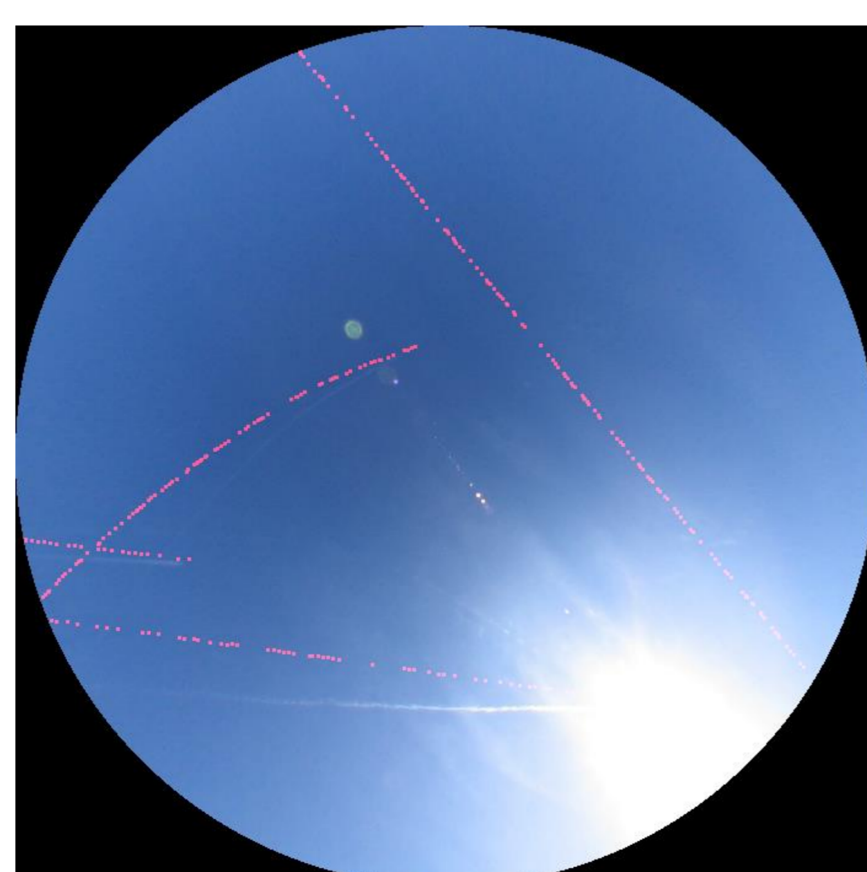
Gauche: Image brute à 10:04 UTC le 12 mars 2015 Droite: Image reprojétée sur une grille orthogonale et restreinte aux angles zénithaux plus petits que 70^\circ . Les trajectoires d'avion des 5 minutes précédentes telles que données par le radar sont indiquées en tireté rouge.
