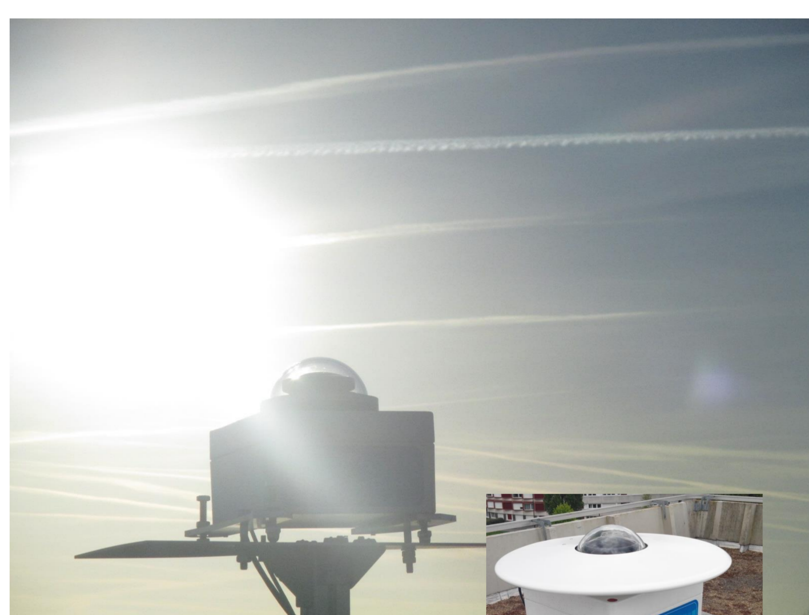
Caméra EKO SRF-02 installée au SIRTA (zone 2)
